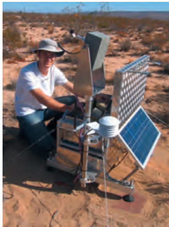
Bild oben: Eine Meteomesstation der Solar Millennium AG.
