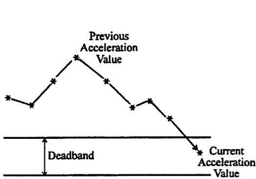
FIGURE 6A. CURRENT ACCELERATION VALUE PASSES INTO DEADBAND
