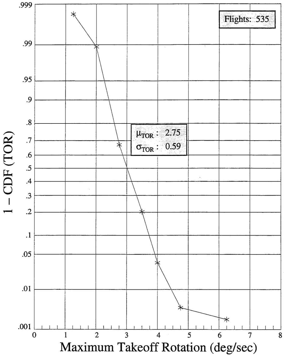
FIGURE 13. CUMULATIVE DISTRIBUTION OF MAXIMUM TAKEOFF ROTATION
