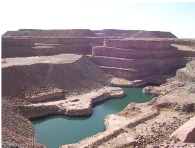
figure 5 : affleurement de la nappe du Tarat au fond de la mine à ciel ouvert Ariège (SOMAIR)
