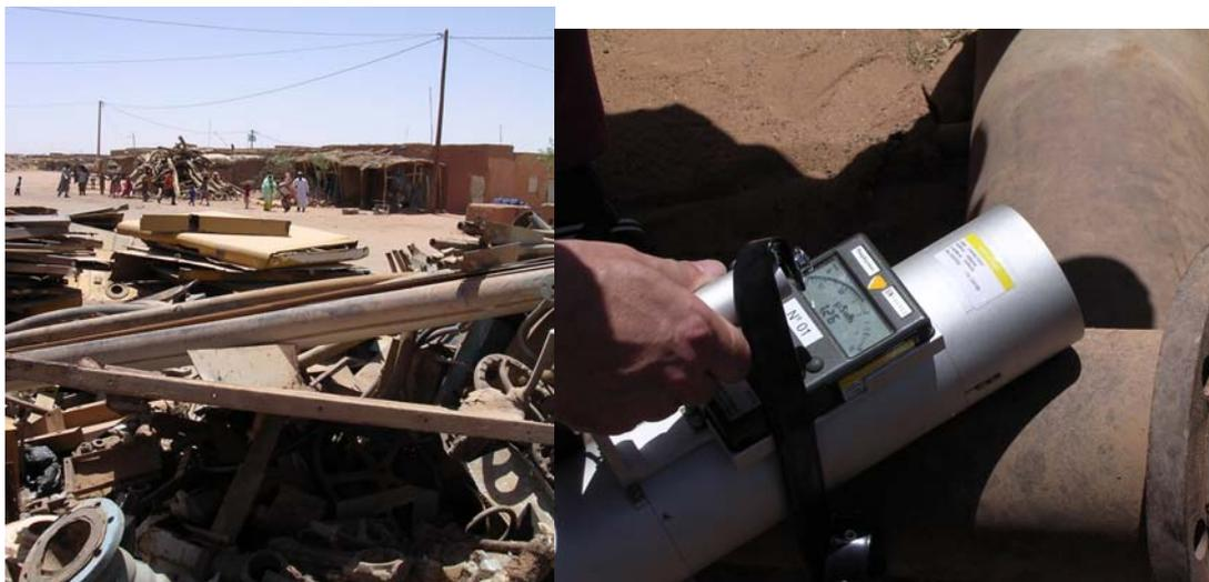
*figure 23 : mesure de débits de dose au marché aux ferrailles d'Arlit*
