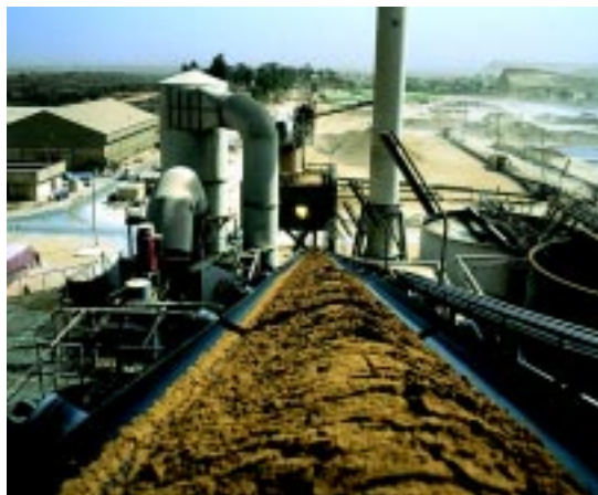
Feeding the phosphoric acid reactor with phosphate rock. Darou, Sénégal. (Industries Chimiques du Sénégal)
